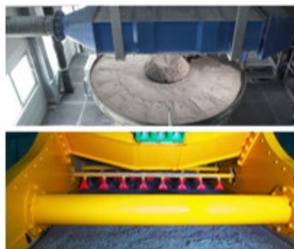
▲ Unsere Reitsandprodukte werden mehrfach gewaschen und durchlaufen einen mehrstufigen Aufbereitungsprozess, z.B. hier gezeigt der Einsatz von Nass-Sieb- und Planfiltertechnologie in der Produktion.
